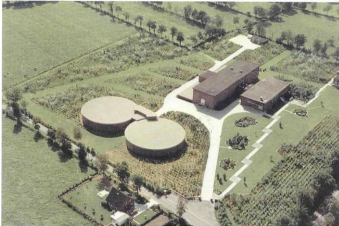
Wasserwerk erreicht die Aufbereitungsleistung von 1400m<sup>3</sup> / Std. und verfügt über einen Behälterraum von 10000m<sup>3</sup> Wasser<sup>16</sup>.
